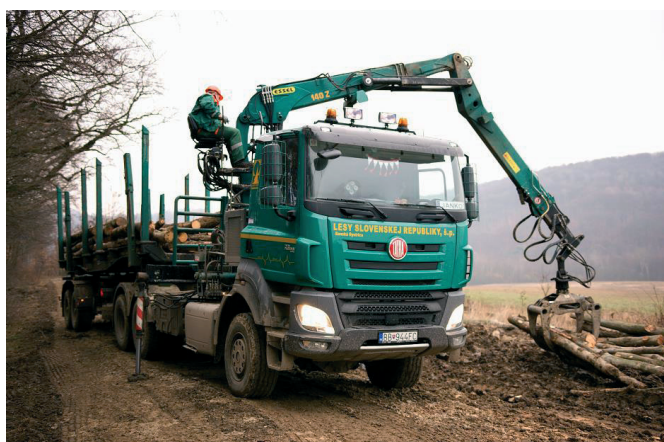
Obr. 1 Tatra Phoenix Euro 6 s hydraulickým nakladacím žeriavom Essel 140Z Fig. 1 Tatra Phoenix Euro 6 with hydraulic crane Essel 140Z
