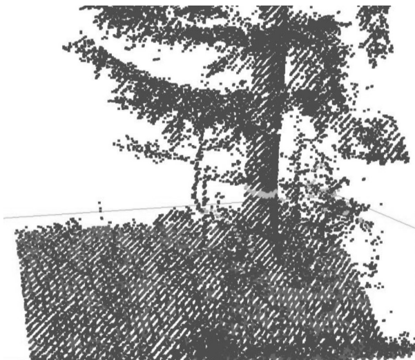
Obr. 1: Znáozornenie klasifikovaného segmentu vo výškovom intervale od 1,25 po 1,35 m. Fig. 1: Illustration of classified segment in height interval from 1.25 to 1.35 m.
