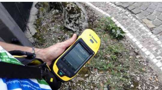
Obr. 4: GPS merania a lokalizácie polygónov pre potreby spracovania satelitných snímok (9/2017)
