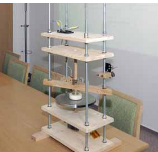
Funkčný vzor zariadenia s magneticky uloženým zotrvačníkom ako súčasť víťaznej práce Bc. Ľuboša Dugasa v rámci sekcii „Spin-off“
