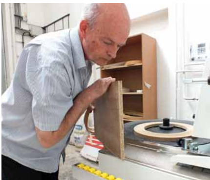
Riaditeľ VDL Ing. Jaroslav Ohanka, CSc., vysvetľuje proces lepenia hrán drevotriekovej dosky.
