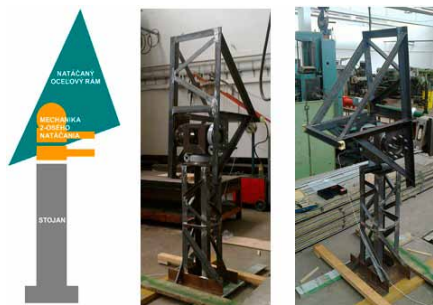
Obr. 6 Stojan, mechanika dvojsoseho natáčania a natáčaný oceľový rám
