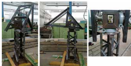
Obr. 7 Rôzne funkčné polohy a detaily koncentrátor (vľavo: pracovná poloha – koncentračné zrkadlá natočené smerom k oblohe pod uhlom 45°; v strede: bezpečná poloha v prípade silného vetra, krupobitá a pod. – koncentračné zrkadlá natočené smerom dole; vpravo: detail otočnej hlavy a integrovaných prevodov)
