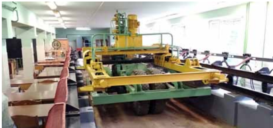
Zariadenie na testovanie odolnosti podložia, lesne meliorácie a cesty
