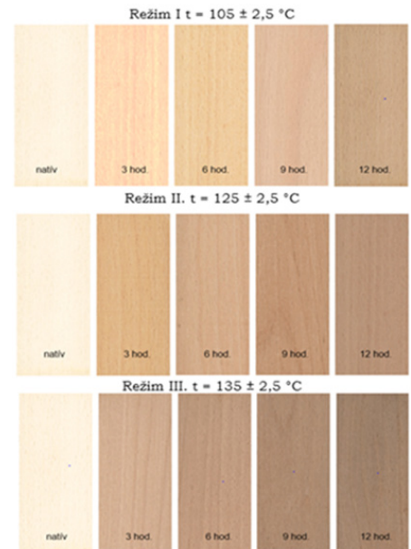
Obr.1 Farba pareného bukového dreva v procese parenia v závislosti od teploty a času
