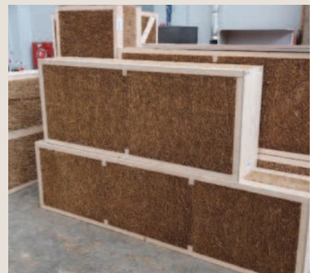
Dreveno-slamený konštrukčný systém EcoCocon.
