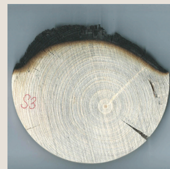
Rez vzorkou smrekového guliáča po zaťažení radiacným zdrojom
