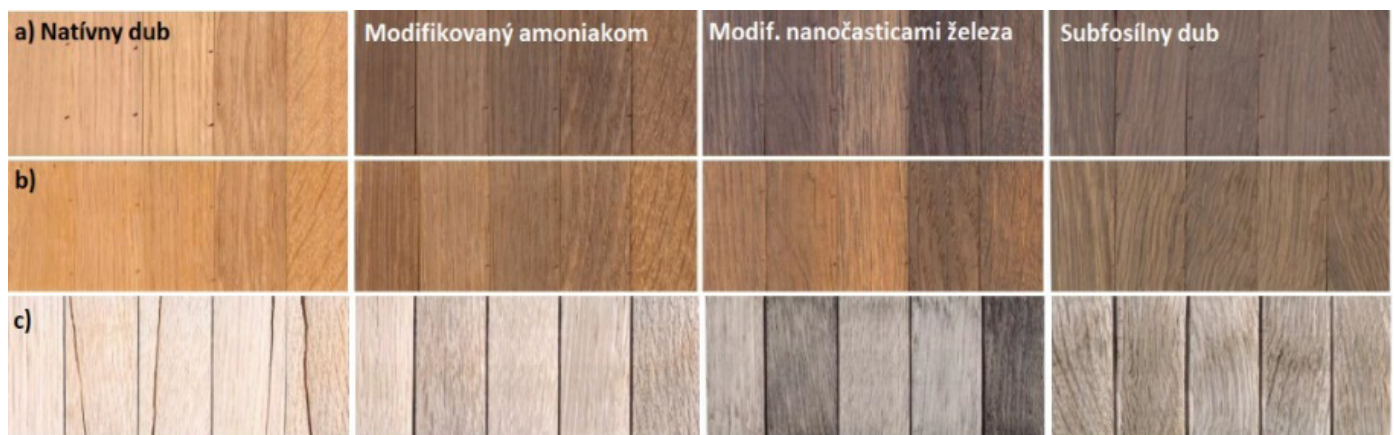
Obr. 1 Farba dubového dreva po modifikácii plynným amoniakom a nanočasticami železa a jej zmena po urýchlennom starnutí. a) pred starnutím, b) po 500 hod. starnutia (suchý režim), c) po 100 hod. starnutia (mokrý režim)
